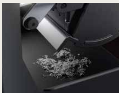
Die Asche fällt automatisch in die darunterliegende große Aschenlade
