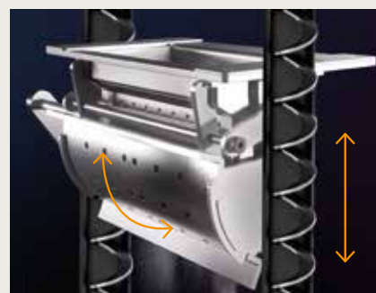
Gleichzeitig mit der Entleerung der Brennschale werden die Turbolatoren in Betrieb gesetzt, um Rußrückstände von den Wärmetauschern zu entfernen (nur bei einigen Hydromodellen)
