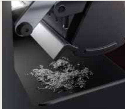
Die Asche fällt automatisch in die darunterliegende große Aschenlade
